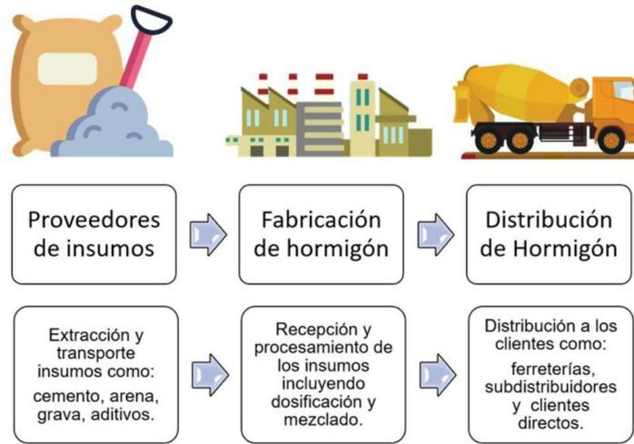
[332] El primer eslabón de la cadena de valor corresponde a los proveedores de insumos. Inicia con la extracción de cantera, procesamiento y adquisición de los materiales como: cemento, áridos (grava, gravilla y arena), agua y aditivos; así como su posterior transporte hacia la planta de producción de hormigón.
